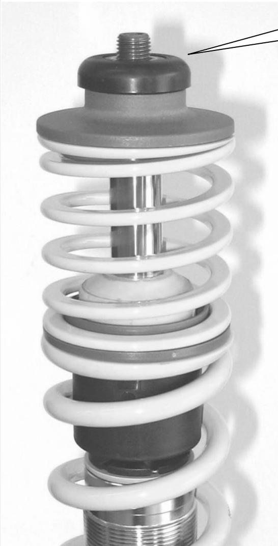
Angeliefertes Federbein mit aufgestecktem Serien Axiallager.
