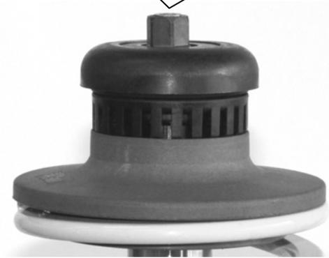
Das Seriendomlager aufsetzen und mit der originalen Befestigungsschraube verschrauben. Das Anzugsdrehmoment der Kolbenstangenbefestigung beträgt 50 Nm. Die Montagehinweise zum Einbau des Federbeines in das Fahrzeug, sowie die Anzugsdrehmomente der Federbeinbefestigung, entnehmen Sie bitte den Unterlagen des Fahrzeugherstellers.
