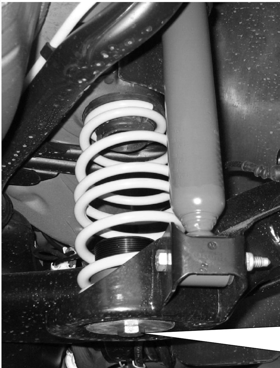
Ist am HA Stützlager ein Kunststoffring verbaut, muss dieser entfernt werden.
