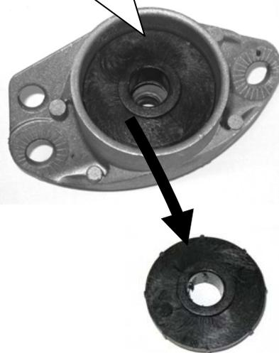
Höhenverstellung einsetzen, und mit Unterlegscheibe und Schraube verschrauben. (Anzugsmoment 25Nm).
